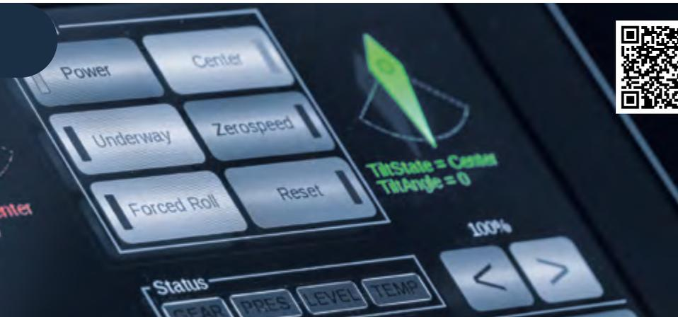
Erweitertes Betriebssystem für alle Yachten mit vorhandenen Flossenstabilisatoren
