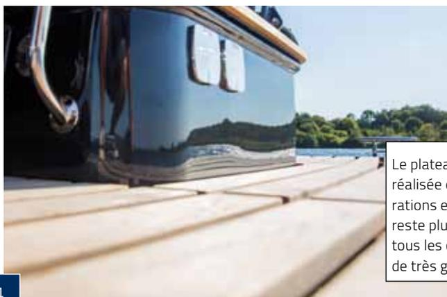
Le plateau de plongée est un module préfabriqué de série réalisée entièrement en acier inoxydable. Toutes les opérations et alésages se font au préalable, de sorte qu'il ne reste plus après le traitement anticorrosion qu'à assembler tous les composants. Cela permet de garantir une finition de très grande qualité.
