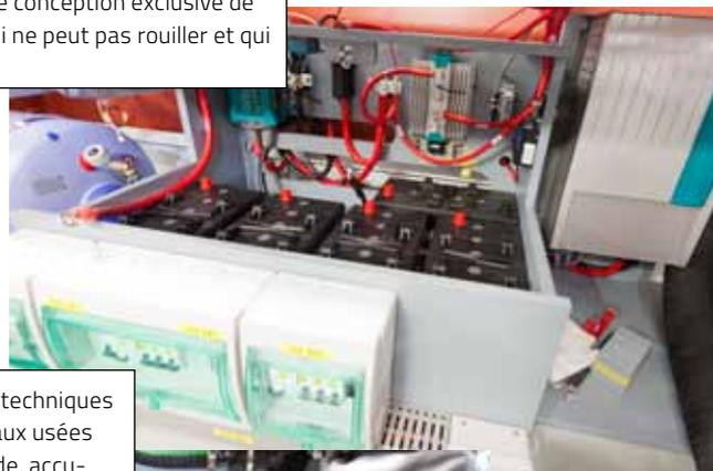
Dans leur majeure partie, tous les composants techniques (moteur(s), réservoir de carburant, d'eau et d'eaux usées (produits exclusifs Linssen), ballons d'eau chaude, accumulateurs, pompes, modules électriques) sont équipés de leurs conduites, flexibles et/ou câbles avant d'être montés dans le bateau.
