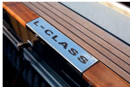
la cabine sont également en teck massif laqué. Un logo unique de la classe L en acier inoxydable haute brillance complète l'aspect luxueux du plat-bord et sert également de cadre de protection à l'ouverture du garde-corps. ◆
